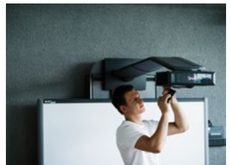
Damit's wieder etwas zu sehen gibt: Austausch des Leuchtmittels im Beamer eines interaktiven Whiteboards
