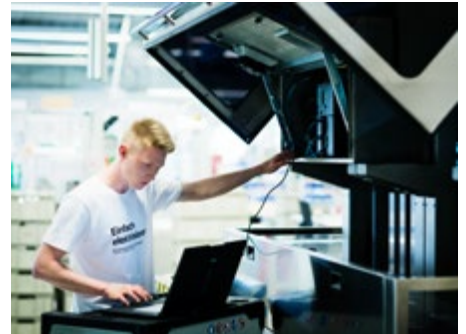
Wo liegt der Fehler? Auslesen und anschließendes Optimieren der Steuerungsdaten am Laptop
